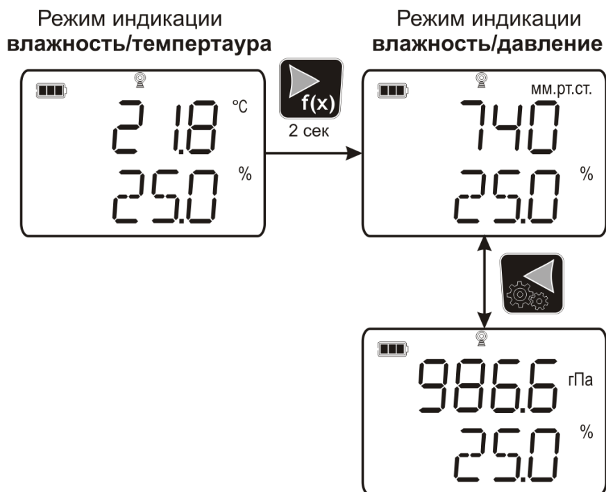
Рисунок 5.2 Переключение режимов индикации ИВТМ-7 М 4-Д-1
